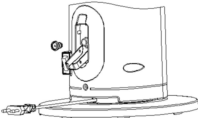
Entfernen Sie den Wasserstopfen und lassen Sie das restliche Wasser im Tank ab.
