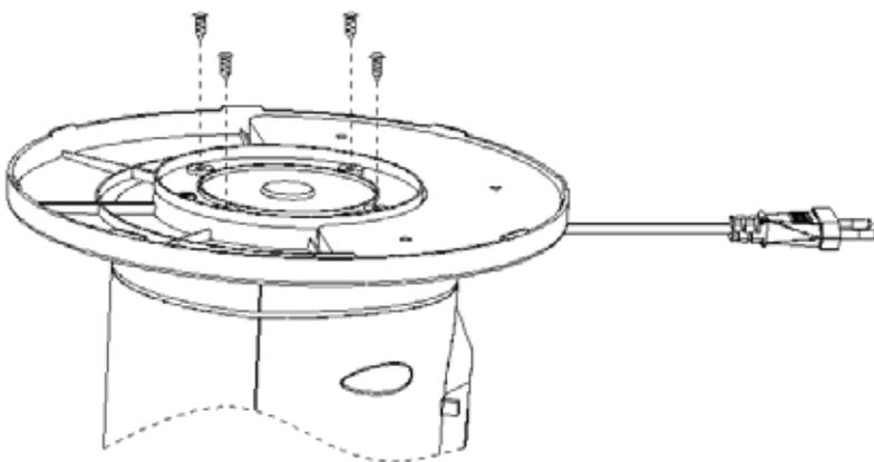
Befestigen Sie den Produktfuß mit Hilfe der 4 mitgelieferten Schrauben und einem Schraubendreher am Produktkörper. Stellen Sie den Produktkörper dafür auf den Kopf.
