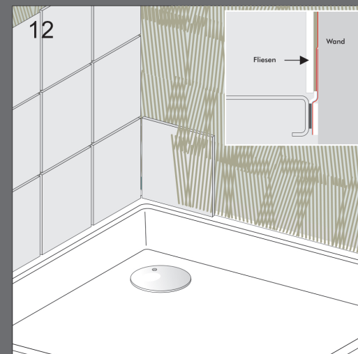
12 Abdeckfolie vom Stoßverbinderklebeband abziehen und Dichtbahn überlappend auf Eckklebeband und Wannenfugenband aufbringen.
